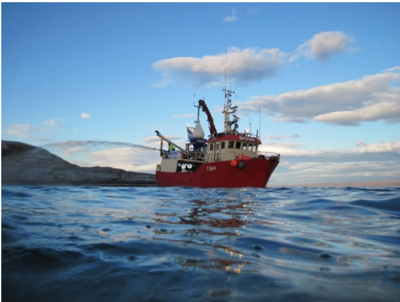
Figur 9. Havforskningsinstituttet har i samarbeid med NIVA og industriaktører som Franzefoss Minerals AS ledet arbeidet med å videreutvikle kalkingsmetodikken, og tilpasse den norske forhold. Her fra kalking i Porsangerfjorden i 2013. Foto: Havforskningsinstituttet
